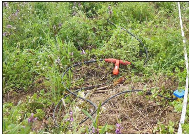
Figura 2: Geofono da 4.5 Hz e cavo sismico.
