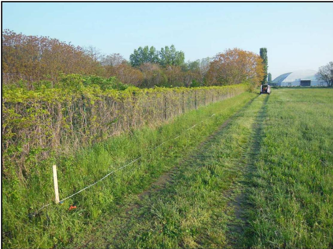
**Figura 1:** Stendimento sismico con interasse 4 metri.
