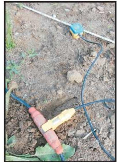
*Fotografia n.3 – dettaglio strumentazione e geofoni*
