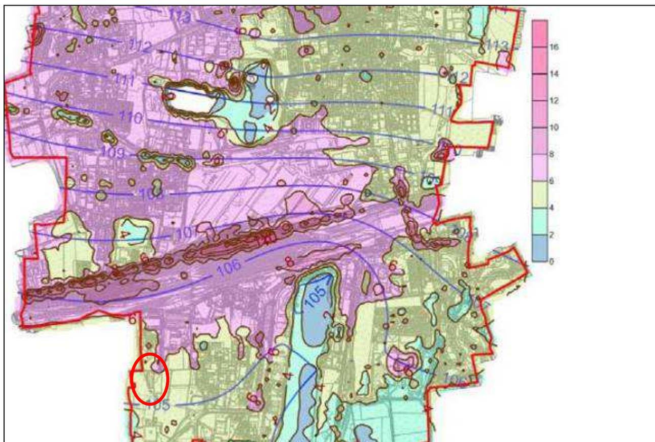
Figura 20: Soggiacenza della superficie piezometrica (Fonte: Componente Geologica del PGT di Segrate)
