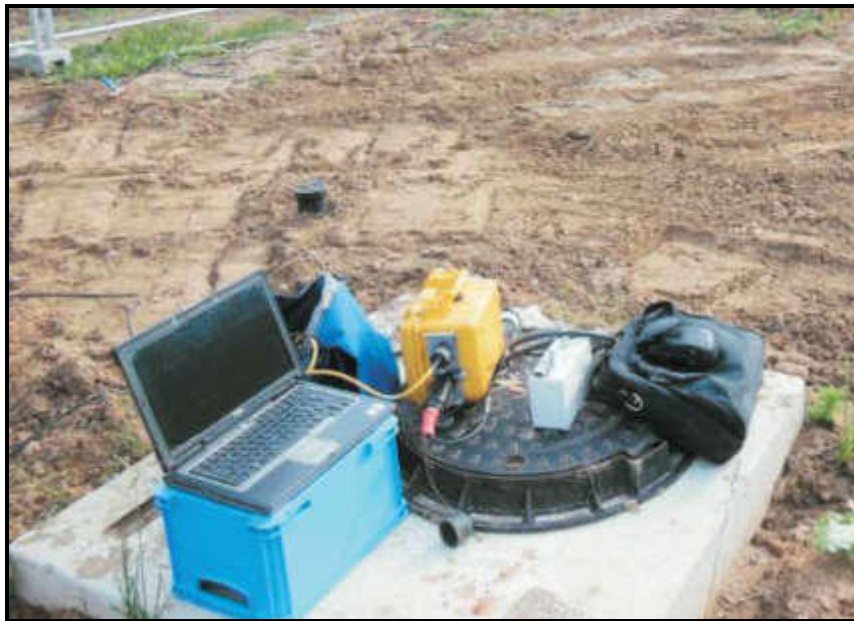
Fotografia n.3 – dettaglio strumentazione e geofoni
