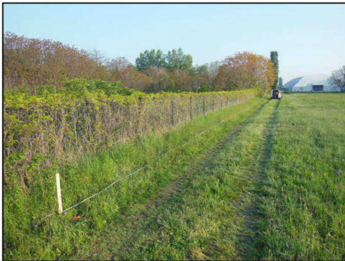
Figura 1: Stendimento sismico con interasse 4 metri.
