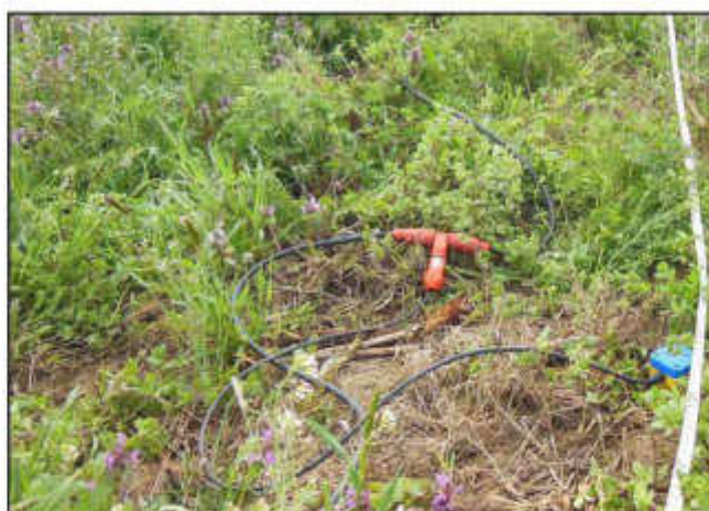
Figura 2: Geofono da 4.5 Hz e cavo sismico.
