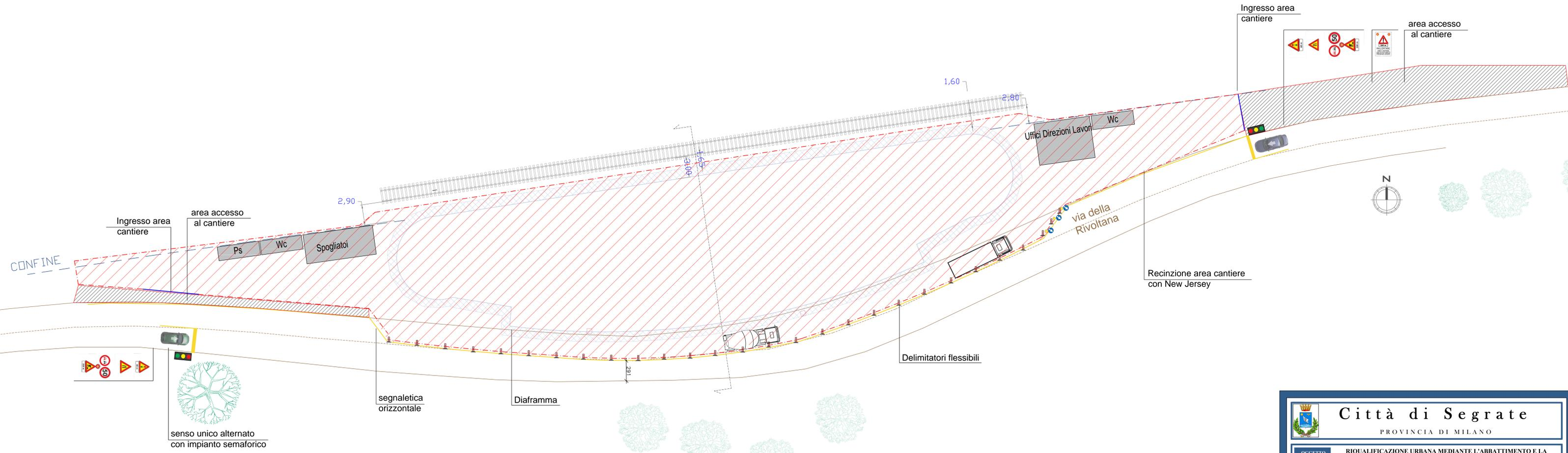
**Fase 1** - L'area di cantiere occuperà parte della carreggiata di via Rivoltana, pertanto si avrà un restringimento della stessa, limitando la viabilità ad una corsia, con senso unico alternato. Tale restringimento verrà gestito da un impianto semaforico e delimitato da segnaletica sia verticale che orizzontale ad alta visibilità.
