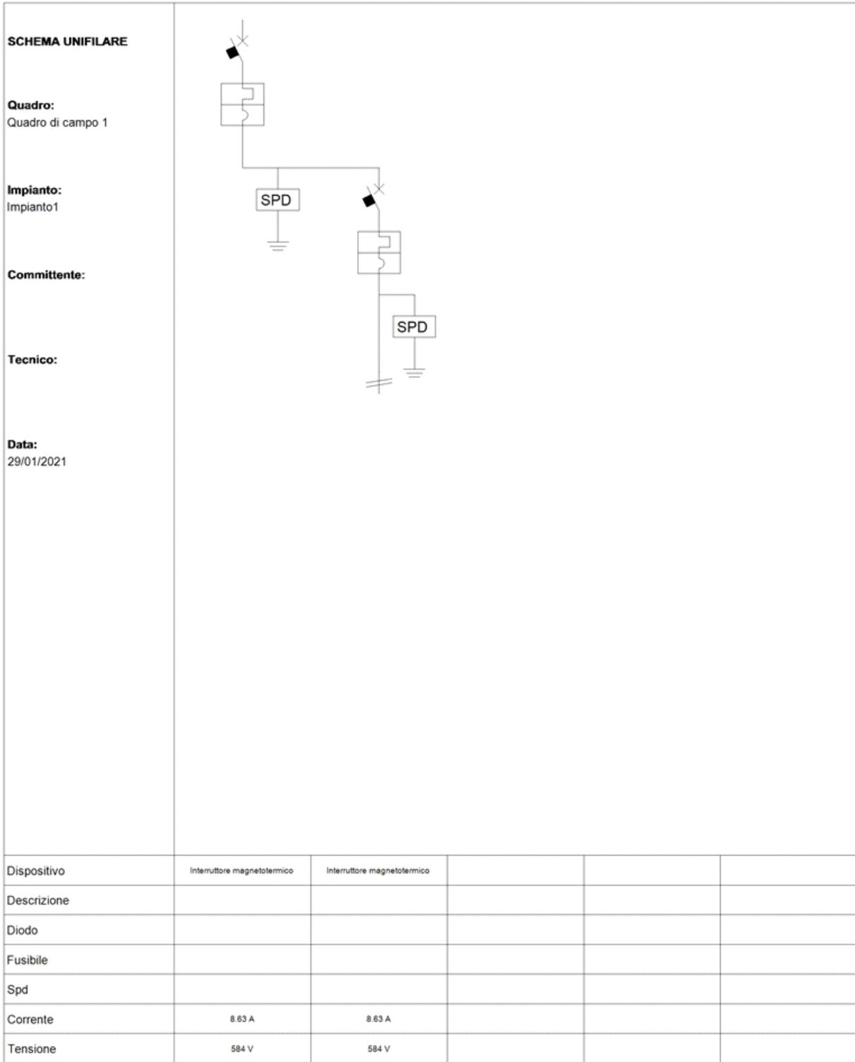
Fig. 8: Schema unifilare quadro "Quadro di campo 1"
